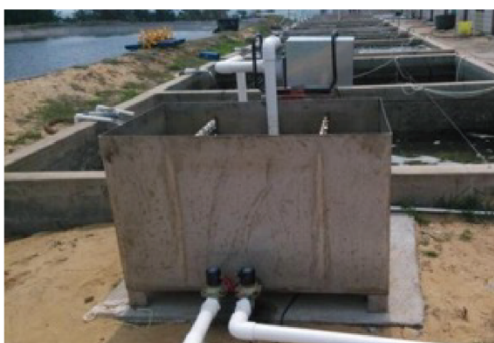
试验站实海加速腐蚀试验装置
